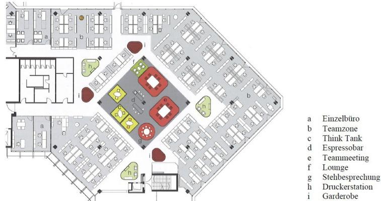
**Abbildung 5:** Schemagrundriss Multi-Space-Büro (Quelle: Schittich (2011), S. 13)
